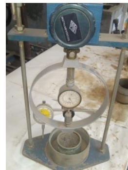
(d) Test for Swelling Pressure
